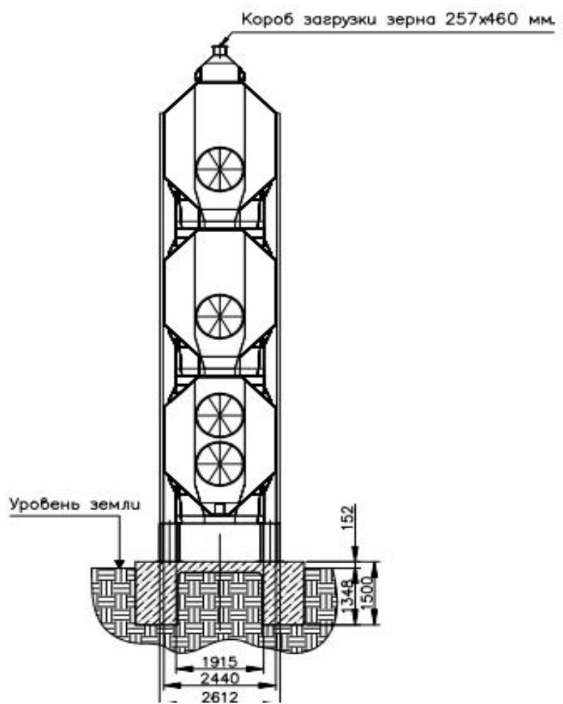
Рис. 1 Модульная зерносушилка АЭРОgrain
